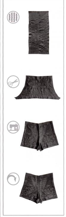
Abb. 3: Die Arbeitsschritte zur Herstellung der 3D-Shape-Höschen
