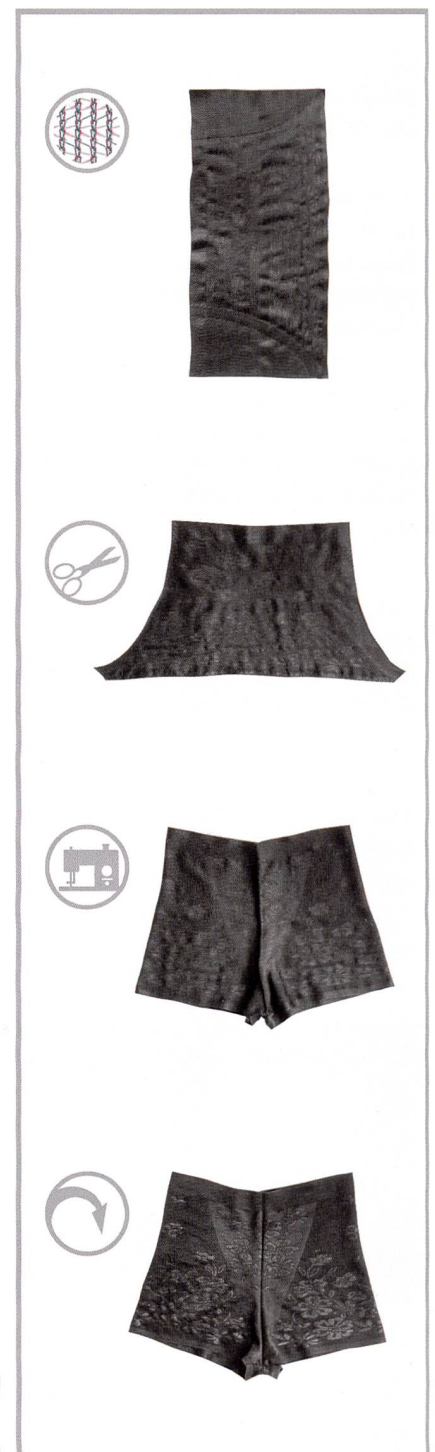
Abb. 3: Die Arbeitsschritte zur Herstellung der 3D-Shape-Höschen
