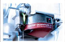
Abb. 5: USTER® QUANTUM 3 auf einer Spulmaschine
