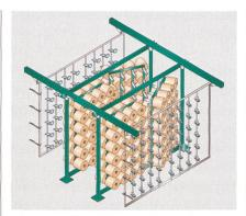
Abb. 3: Aufbauskizze des Drehrahmengatters GD
