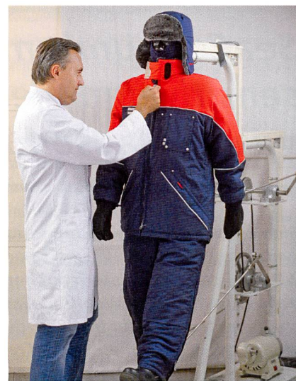
Abb. 3: Kein Nässegefühl mehr – optimierte Wärmeschutzkleidung wird an den Hohenstein Instituten mit Hilfe der Testpuppe «Charlie» getestet. ©Hohenstein Institute
