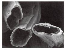
Abb. 1: Stark vergrösserte Darstellung von Cellulose-Regeneratfasern im Querschnitt. ©Kelbeim Fibres
