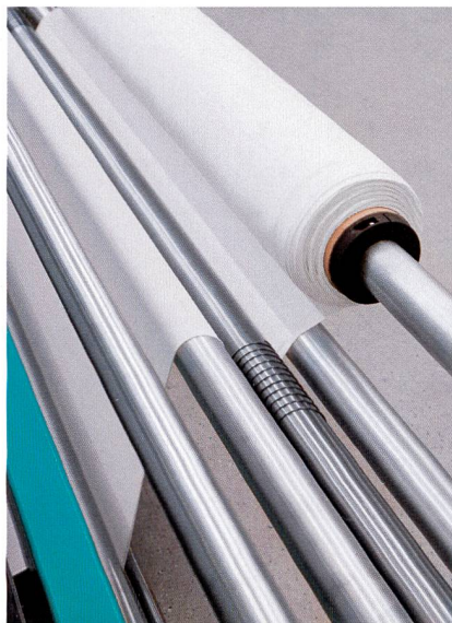
Abb. 3: Die Ausstreichereinrichtung mit dem Spiralfeder-Profil zum Breitreichen der Ware
