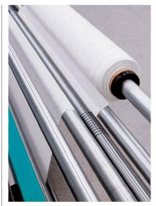
Abb. 3: Die Ausstreicheinrichtung mit dem Spiralfeder-Profil zum Breitstreichen der Ware
