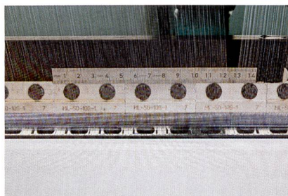
Abb. 2: Die aussergewöhnliche Feinheit von E 50 mit einem Millimeter-Massstab zur Veranschaulichung
