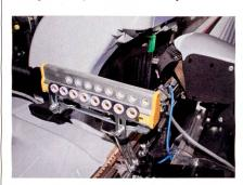
Abb. 1: Der Maestro-Schussfadenwächter an der Greiferwebmaschine Silver 501
