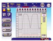
Abb. 4: Der Schussfadensensor überträgt für alle Positionen das Sensorsignal mit hober Geschwindigkeit. Das Signal zeigt deutlich, wie der Schussfaden durch das Fach bewegt wird.
