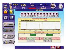
Abb. 3: Der Schusseintrag wird in zwei Bereichen überwacht
