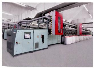
Abb. 2: Die Luftspinnmaschine J 20 mit bis zu 120 hochproduktiven Spinneinheiten
