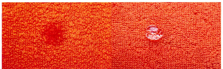
Abb. 2: Lenzing Modal® Frottee (links) saugt Wasser sofort auf. Auf Baumwollfrottee (rechts) bleiben Wassertropfen auf der Oberfläche.
