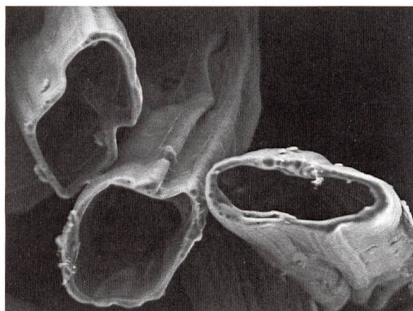
Abb. 1: Stark vergrößerte Darstellung von Cellulose-Regeneratfasern im Querschnitt. ©Kelheim Fibres
