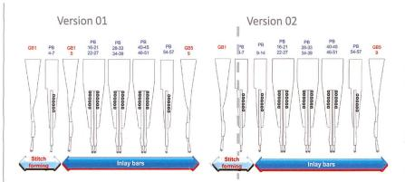
Abb. 2: Die Standard-Barrenanordnung der ML 46
