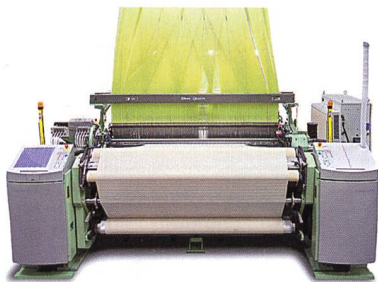
Abb. 1: Hochwertiges Jacquardgewebe auf einer Luftwebmaschine Typ AWS8/J G in 220 cm MNB
