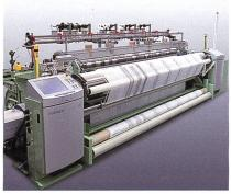
Abb. 2: Gardinengewebe mit Stickeinrichtung auf einer Luftwebmaschine Typ AWS4/S 12 C in 360 cm MNB
