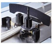
Abb. 4: Neuer Einlaufsensor TD-DL
