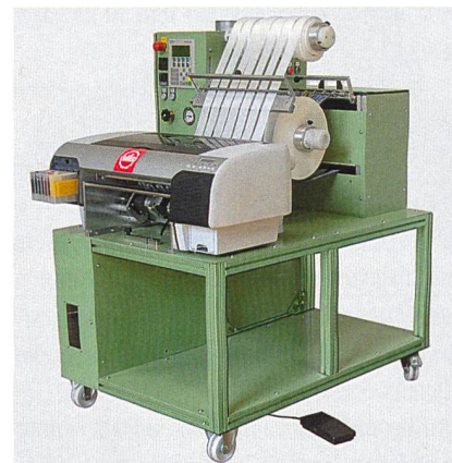
Abb. 5: MDP2 MÜPRINT2 – Inkjet-Direkt-drucksystem für textile Bänder
