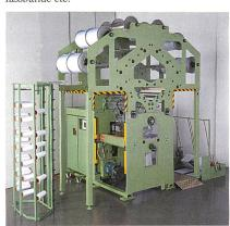
Abb. 4: Elektronisch gesteuerte Rechts-Rechts-Raschelmaschine — MDK80D — für elastische und nicht-elastische Wirkwaren für Bekleidung und technische Anwendungen
