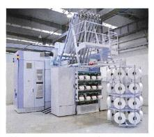
Abb. 1: Die neue automatische Texturiermaschine eFKA
