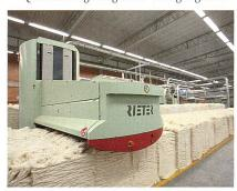
Abb. 2: Der automatische Ballenöffner UNIfloc A 11 erzeugt kleine Flocken zu Beginn des Prozesses
