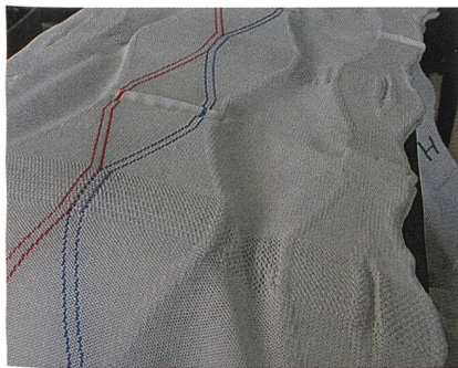
Abb. 2: Konturennahe gefertigtes Abstandsgewirke von der HighDistance®
