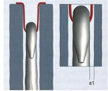
Abb. 6: Fadenfreiraum zwischen Nadel und Platine: zylindrischer Haken
