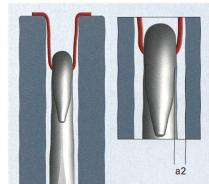
Abb. 5: Fadenfreiraum zwischen Nadel und Platine: konischer Haken
