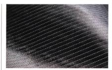
Abb. 1: Gewirke aus Kohlenstofffasern, Foto: Karl Mayer Textilmaschinenfabrik
