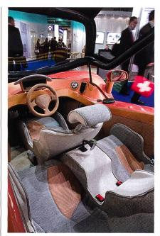
Abb.4: Sitzformteile tragen zur Gewichtseinsparung im Automobilbau bei
