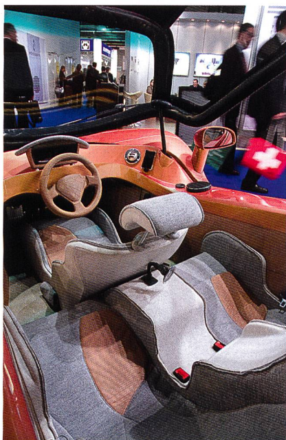
Abb. 4: Sitzformteile tragen zur Gewichtseinsparung im Automobilbau bei
