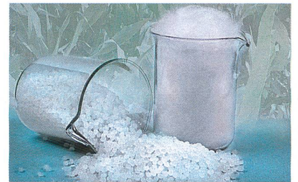
Abb. 2: Fasern aus Biopolymeren (PLA / Ingeo™) (Foto: Trevira)
