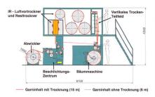
Abb. 2: Doppelstock-Aufbau minimiert den Platzbedarf
