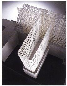
Abb. 2: Gelege aus alkali-resistentem (AR)-Glas – Endlosrovings
