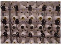
Abb. 2. Reduzierter Ballonbegrenzer der bisberigen Lösung für die Fadenspannerelemente
