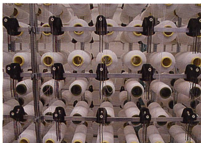
Abb. 2. Reduzierter Ballonbegrenzer der bisherigen Lösung für die Fadenspannerelemente
