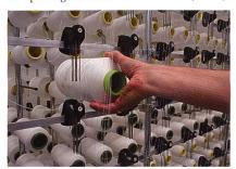
Abb. 1. Spulenwechsel am herkömmlichen Querabzugsgatter
