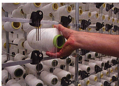
Abb. 1. Spulenwechsel am herkömmlichen Querabzugsgatter
