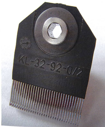
Abb. 4: Die neue, durchgängig gestaltete Schraube zur Befestigung der Lochnadelfassungen
