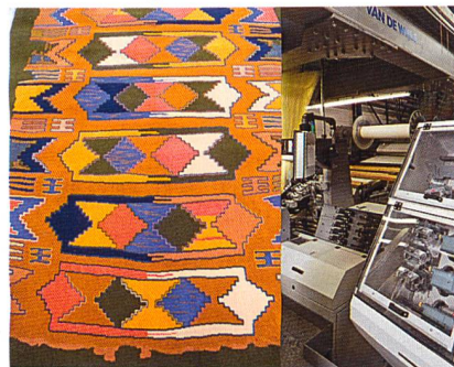
Abb. 2: Handlook Carpet Pioneer HCP X2 produziert Teppiche in Handknüpfoptik mit nicht sichtbaren Kettfäden auf der Rückseite
