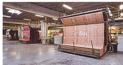
Abb. 1: Im Vergleich zur Standardbreite von 4 Metern ermöglicht die 5 Meter breite Maschine Kombinationen von 2 und 3 Meter breiten Teppichen und Läufern
