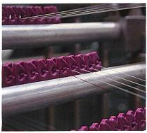
Abb. 3: Fadenführungsorgane mit offener, einfädelbarer Öse
