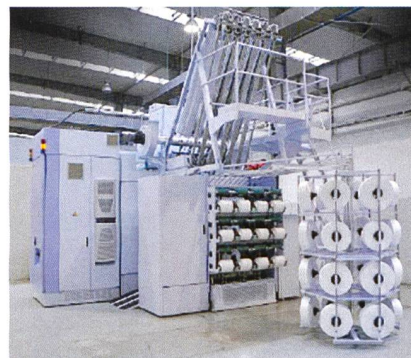
Abb. 1: Die neue automatische Texturiermaschine eFKA
