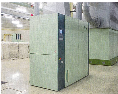
Abb. 3: Der Vorreiniger UNiclean B 12 ist die effiziente Reinigungs- und Entstaubungsmaschine, die direkt nach der Ballenabtragung eingesetzt wird
