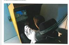
Abb. 1: In kontrollierten Sitzversuchen mit Testpersonen werden unter variierten Klimabedingungen die Temperaturen, relative Feuchte und Wärmeflüsse an verschiedensten Positionen im System Fabrer, Sitz und Fabrzeuginnenraum gemessen
