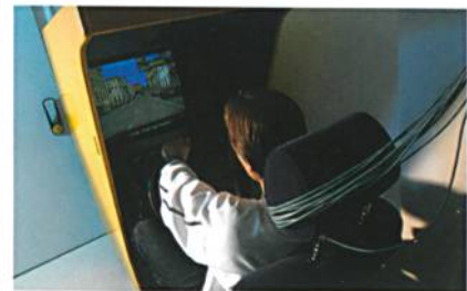
Abb. 1: In kontrollierten Sitzversuchen mit Testpersonen werden unter variierten Klimabedingungen die Temperaturen, relative Feuchte und Wärmeflüsse an verschiedensten Positionen im System Fahrer, Sitz und Fahrzeuginnenraum gemessen
