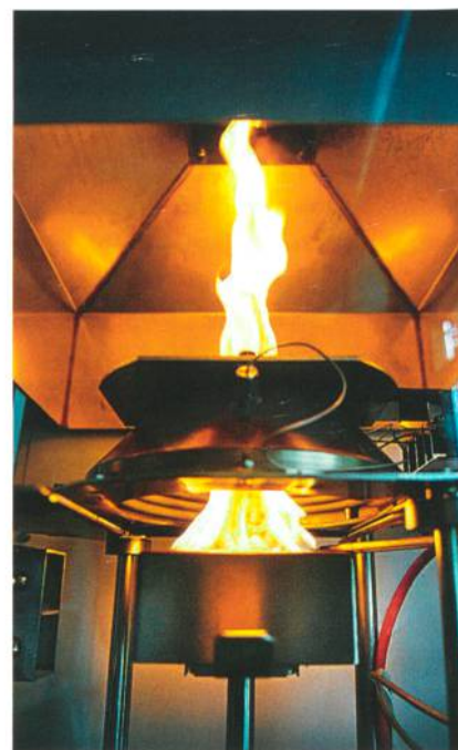
Abb. 2: Cone Calorimeter Tests nach ISO 5660-1
