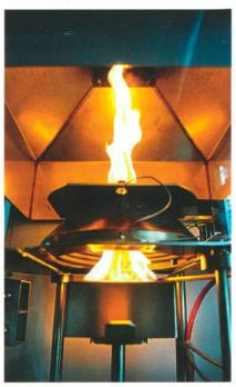
Abb. 2: Cone Calorimeter Tests nach ISO 5660-1
