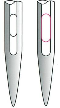
Abb. 3: Spezial-Stick-Öhr: Das Öhr ist bier um zwei Stärken vergrössert, z. B hat eine Nadel der Dicke 70/10 das Öhr einer Nadeldicke 90/14; Quelle: Schmetz
