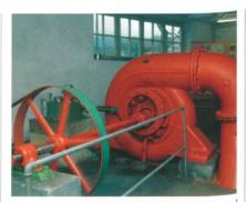
Abb. 2: Die Turbine aus dem Jahre 1862 wird vom Wasser der Luteren angetrieben und produziert heute jährlich rund 80'000 Kilowattstunden elektrische Energie
