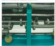
Abb. 1: Die in Teilstücke segmentierte Welle zum Antrieb der Barren
