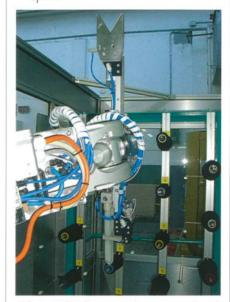
Abb. 2: Pick&Place-Einrichtung mit Schneidwerkzeug (oben)
