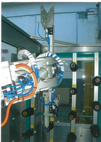
Abb. 2: Pick&Place-Einrichtung mit Schneidwerkzeug (oben)
