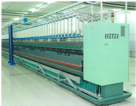
Abb. 1: Ringspinnmaschine G32
