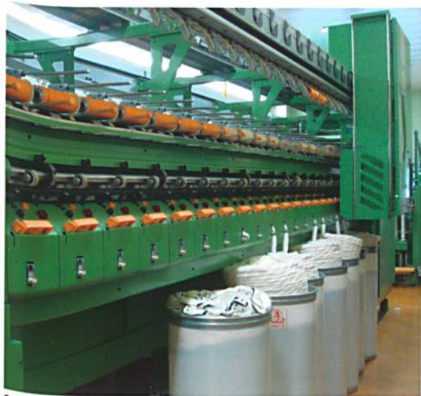
Open-End Spinnmaschine im Technikum Wattwil
