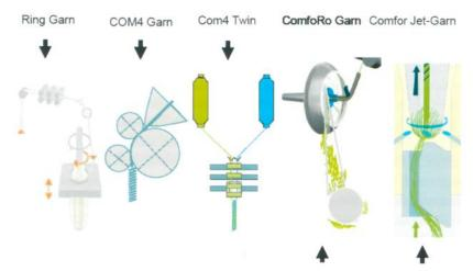
Abb. 4: Schematische Darstellung der verschiedenen Spinntechnologien; Bild: Rieter
