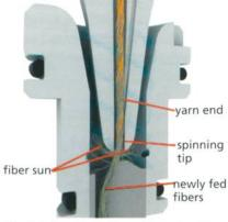
Abb. 5: Schematische Darstellung des Spinnkopfes der Luftspinnmaschine ComforJet J 10; Bild: Rieter
