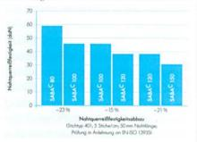
Abb. 5: Nabtquerreissfestigkeit bei PES/PES-Umspinnzwirn verschiedener Stärken
