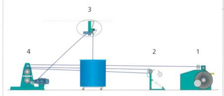
Abb. 2: Long Chain Beamer LCB: 1 – Bäummaschine, 2 – Tänzerwalzen-Zugkraftregelung, 3 – gegenläufig angetriebener Kompensator, 4 – Spannungsvorrichtung
