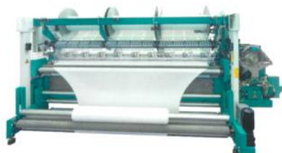
Abb. 2: Die HKS 2-3 E mit CFK-Technologie der 2. Generation und hier mit der Arbeitsbreite von 130"
