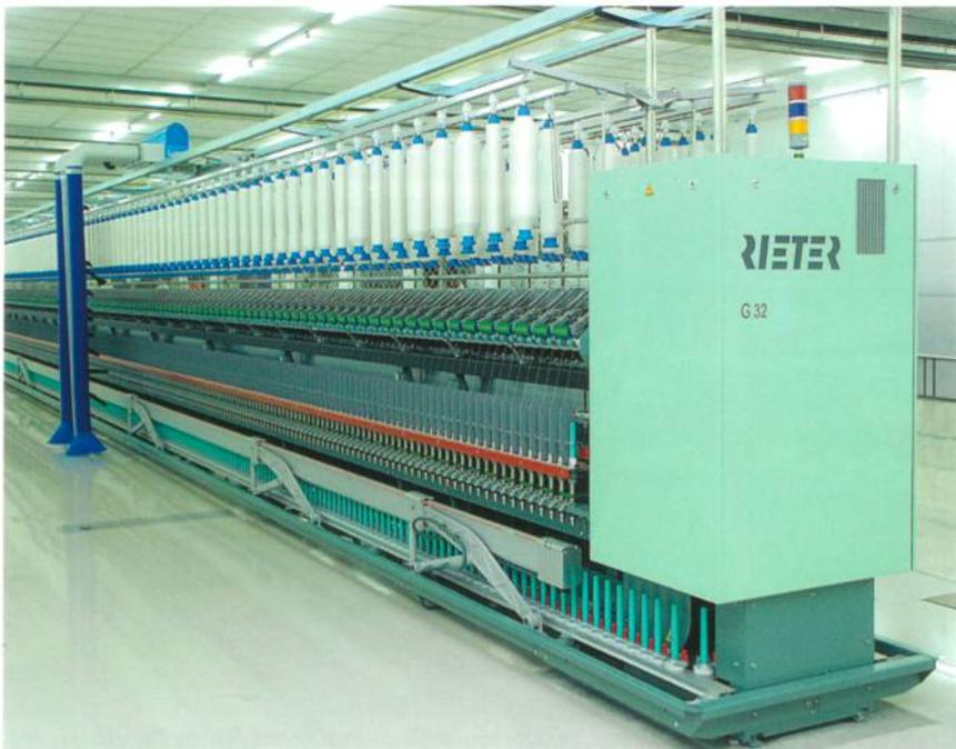
Abb. 1: Ringspinnmaschine G32
