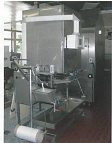
**Zettelanlage mit Gatter****Zettelmaschine Type MW400 (für Bandwebmaschinen)****Schnellschärgatter Typ GDS/V-Standard mit 192 Aufsteckstellen****Hersteller: Jakob Müller AG Frick****Welche Möglichkeiten hat die Maschine?**
