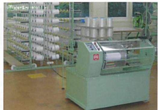
**Flechtmachine****Flechtmachine für die Herstellung von Kordeln, Hohlgeflechten und Seilen****Hersteller: Herzog Flechtmaschinen, Oldenburg (D)****Welche Möglichkeiten hat die Maschine?**
