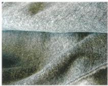
Abb. 2: Schwer entflammbarer Maschenstoff, «Qualität e2»
