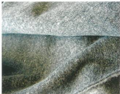
Abb. 2: Schwer entflammbarer Maschenstoff, «Qualität e2»
