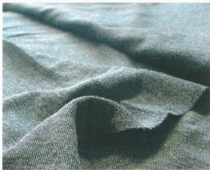
Abb. 1: Schwer entflammbarer Maschenstoff, «Qualität e1» für die Herstellung von Workwear-Bekleidung (alle Bilder: Christian Eschler AG, Bühler/Schweiz)
