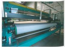
Abb. 1: Durchgängige Transportauflage am Eingang der Maschine
