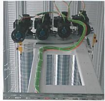
Abb. 4: Stehfadenlieferwerk (Sicht von unten) zwei Walzen mehr notwendig. Der somit entstandene konstruktive Freiraum führt zu einer separierten und damit exakten Leitung der Fadenscharen – frei von gegenseitigen Behinderungen. Für eine 100 %ig präzise Spannungs-
