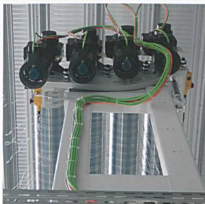
Abb. 4: Stehfadenlieferwerk (Sicht von unten)
