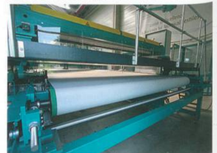
Abb. 1: Durchgängige Transportauflage am Eingang der Maschine
