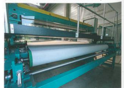
Abb. 1: Durchgängige Transportauflage am Eingang der Maschine
