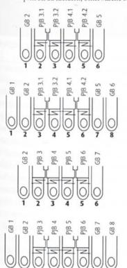
Abb. 1: Legebarreneinteilung von oben nach unten der RDPJ 4/2 (2/2), RDPJ 6/2 (4/2), DJ 4/2 und DJ 6/2
