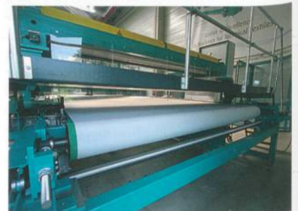
Abb. 1: Durchgängige Transportauflage am Eingang der Maschine
