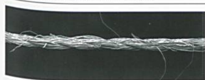
Abb. 9: Garnstruktur Com4®, klassischer Zwirn
