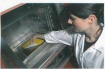
Abb. 2: Mit dem Hautmodell können durch die Simulation der Wärme- und Schweissabgabe der menschlichen Haut verschiedene bekleidungsphysiologische Kennzahlen für ein Textil ermittelt werden
