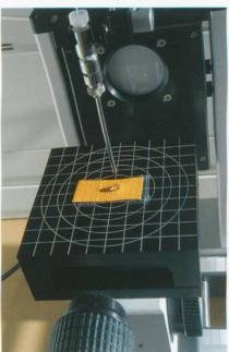
Abb. 1: An den Hobenstein Instituten wird u. a. die Fäbigkeit von Textilien zur Aufnahme und Ableitung von Feuchtigkeit untersucht. Im Bild: Ermittlung des Benetzungsindexes
