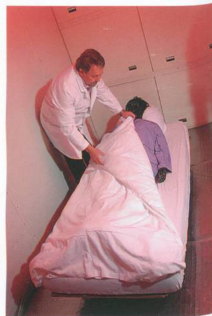
Abb. 3: Mit Hilfe der Gliederpuppe «Charlie» werden die thermophysiologischen Eigenschaften konfektionierter Kleidung oder von Bettdecken gemessen
