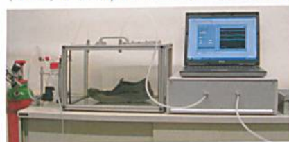
Abb. 2: Mit Hilfe der so genannten «Elektronischen Nase» soll künftig bereits bei der Entwicklung von Schuhen und Strümpfen das Potential für unangenehmen Schweissgeruch abschätzbar sein. Bild: PFI Pirasens
