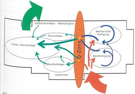
Abb. 1: Der stilisierte Materialfluss durch die Produktionsballe der Fleissner GmbH. Zentral: Die Q-Zone, durch die alles Material aus der eigenen Teilefertigung und von Lieferanten fliesst.
