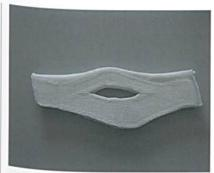
Abb. 3: Eingearbeitete polfadenfreie Zone nach dem Heraustrennen der Deckflächen an dieser Stelle
