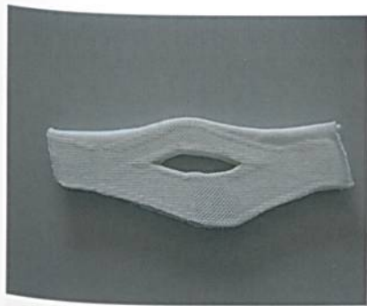
Abb. 3: Eingearbeitete polfadensfreie Zone nach dem Heraustrennen der Deckflächen an dieser Stelle
