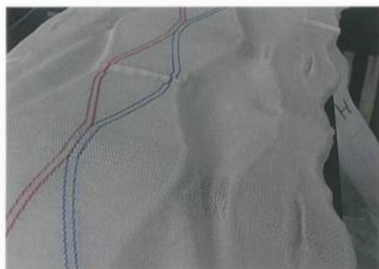
Abb. 1: Bauteile aus Abstandsgewirke am Stück, mit für Anschauungszwecke eingearbeiteten farbigen Polfäden zur Verdeutlichung der Führung der beiden Pollegebarren beim Konturenarbeiten
