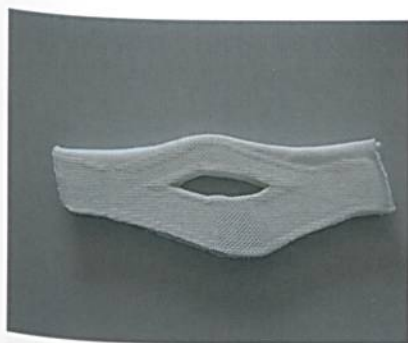
Abb. 3: Eingearbeitete polfadensfreie Zone nach dem Heraustrennen der Deckflächen an dieser Stelle
