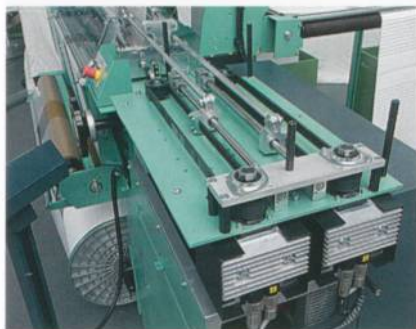
Abb. 4: Servomotorantrieb für Langschüsse von bis zu 450 mm
