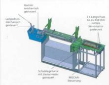
Abb. 3: Grundaufbau der MDC 3/830 E
