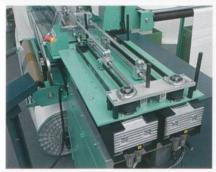
Abb. 4: Servomotorantrieb für Langschüsse von bis zu 450 mm
