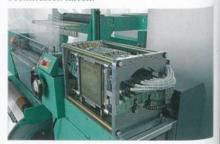
Abb. 2: Linearmotoren zur Steuerung der Legebarren
